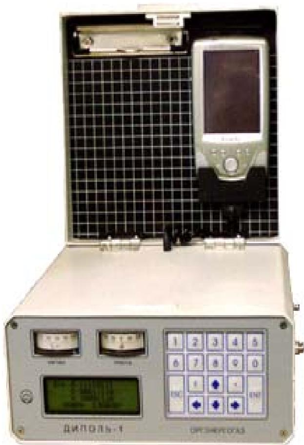
— прогнозировать динамику старения (уменьшения сопротивления) изоляционного покрытия по участкам протяженностью до 20 метров.
